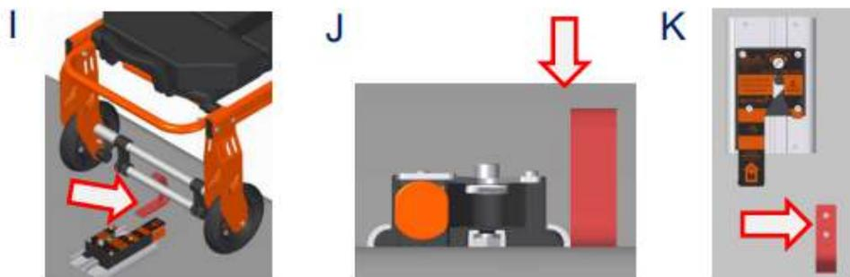
Asegúrese de colocar la camilla correctamente y acoplar los sistemas de anclaje delantero (L) y trasero (M) a la camilla. Luego, coloque el seguro de seguridad (N) y marque los puntos en el piso del vehículo donde se realizará la perforación. Antes de continuar, verifique que la perforación no cause daños a los componentes del vehículo. Utilice una broca de 8 mm de diámetro para realizar el orificio.
