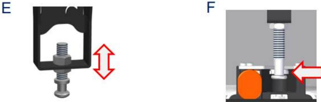
El seguro de fijación se puede ajustar sobre el riel, permitiendo un ajuste fino para reducir cualquier juego en el sistema de anclaje (G). Para realizar la liberación del movimiento del seguro sobre el riel, ubique el tornillo en la superficie del seguro de fijación (H) y, con la ayuda de una llave Allen n.º 8, realice el movimiento en sentido antihorario para liberar y en sentido horario para trabar.
